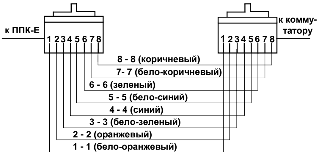
б) Прямой кабель (соединение ППК-Е и коммутатора)
