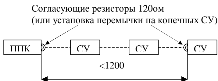
Рис. 5 Подключение сетевых устройств на линию RS-485.
