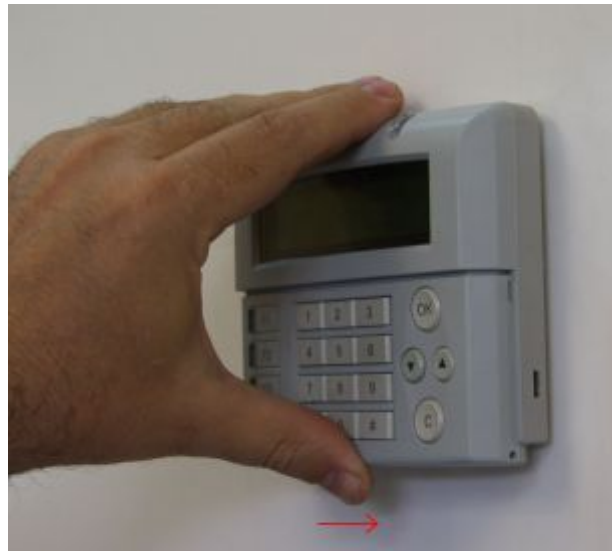
Рис. 4 Снятие и установка крышки ПУО
