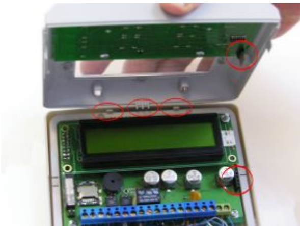
Рис. 4 Снятие и установка крышки ПУО
