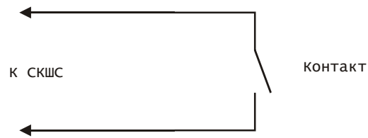
Рис. 5 Схема включения ШС без контроля КЗ и обрыва
