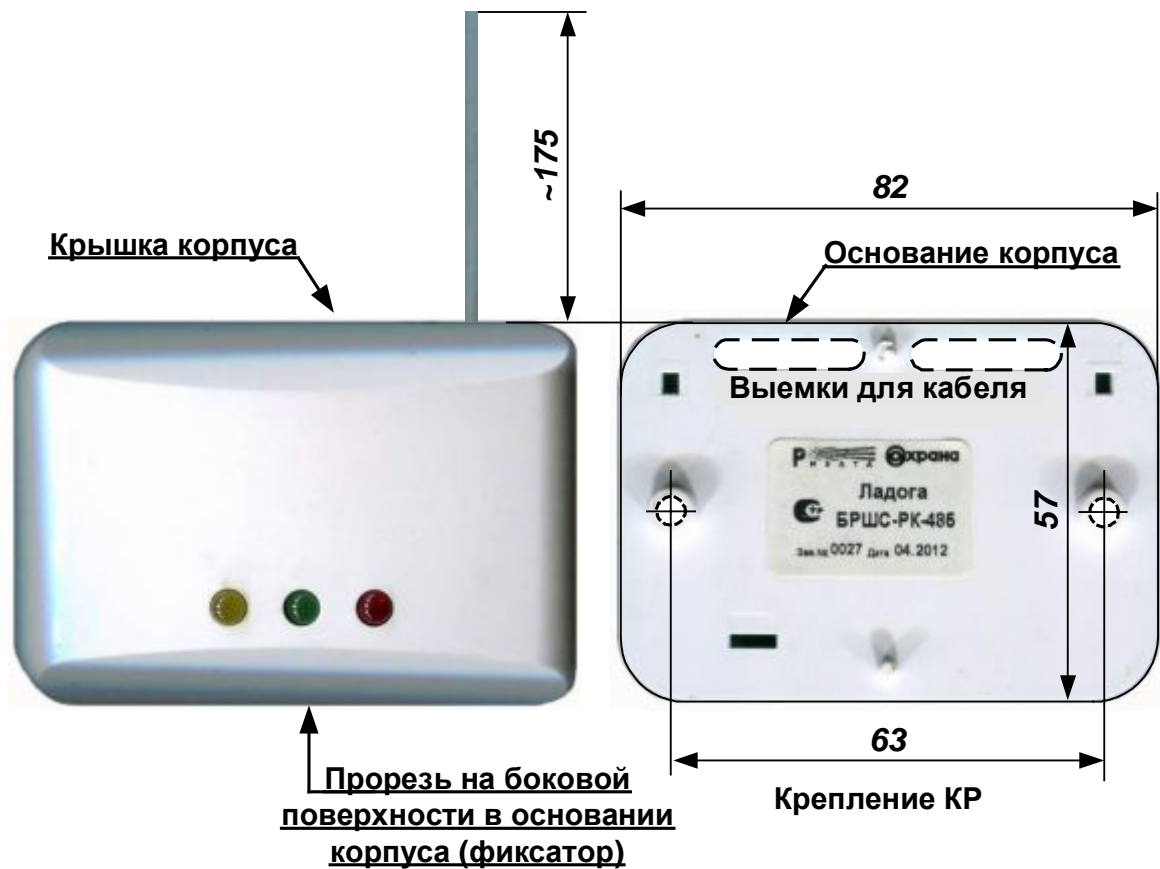
Рис. 3 Габаритные и присоединительные размеры
