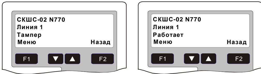
Рис. 7 Окно состояния СКШС при снятой крышке корпуса (слева) и установленной крышке (справа)
