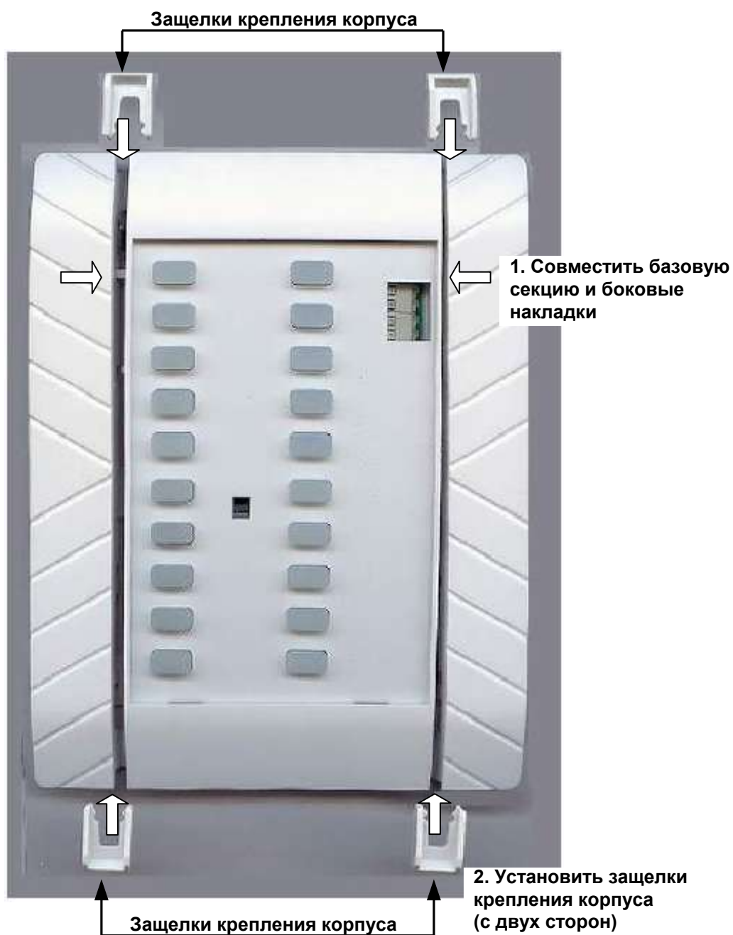
Рисунок 7 – Сборка одного блока БИС-М
