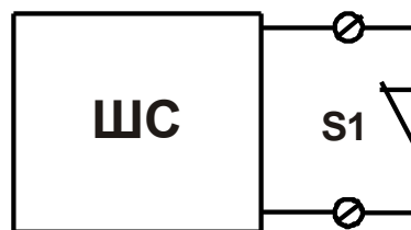
Рис. 17 Подключение извещателя с НО контактами без контроля целостности линии связи
