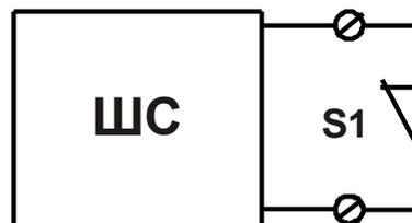
Рис. 11 Подключение извещателя с НЗ контактами без контроля целостности линии связи
