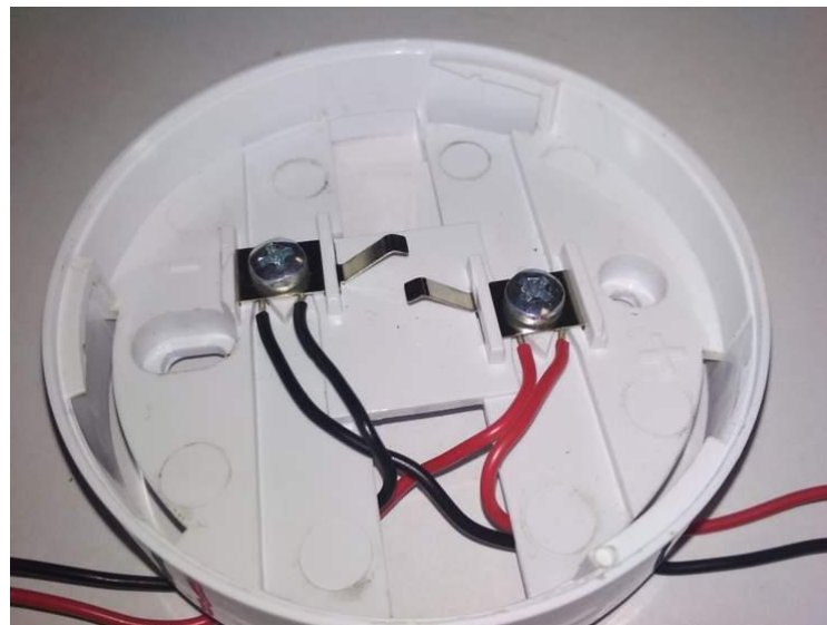
Рис. 6 Присоединение проводов к базе АЗДПИ
