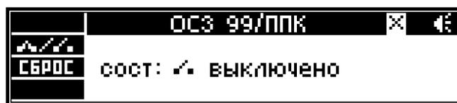
Рисунок 4 – Отображение состояния ОСЗ в меню веб-формы конфигуратора для ППК серии Е, М и Т
