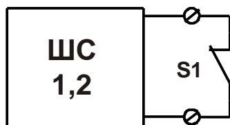
Рис. Схема 5 Подключение извещателя (датчика) с НЗ контактами без контроля целостности линии связи.
