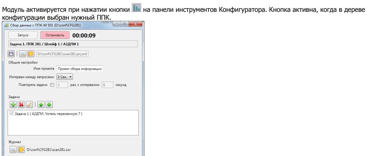
Параметры сканирования задаются в **проекте** сканирования. Он может быть сохранен и впоследствии загружен в Конфигуратор.
