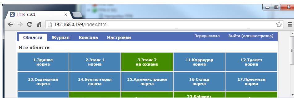
Также возможна навигация по техническим средствам областей, переход по ссылкам на другие области и выполнение операций (Взятие, Снятие, Сброс, Включение, Выключение и т д). Доступные действия представлены в виде первого ряда кнопок при переходе в область или ТС:
