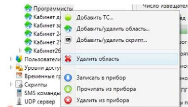
Удаление из Конфигуратора можно произвести без непосредственной связи с прибором, а потом во время сеанса связи записать изменения. Но при этом необходимо записывать родительский узел, из которого удалили подузел. Т.е., если мы удалили из конфигурации область, то чтобы область удалась из конфигурации прибора, необходимо записать все области.
