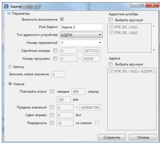
В окне «Задача» задаются условия для каждой задачи индивидуально. Здесь можно задать Имя Задачи, которое вместе с пояснением отображается в списке задач окна «Сбор данных». Для задачи из списка выбирается Тип адресного устройства и Номер переменной. Дополнительно можно уточнить интервал серийных номеров выбранного типа устройств и номер их прошивки.
