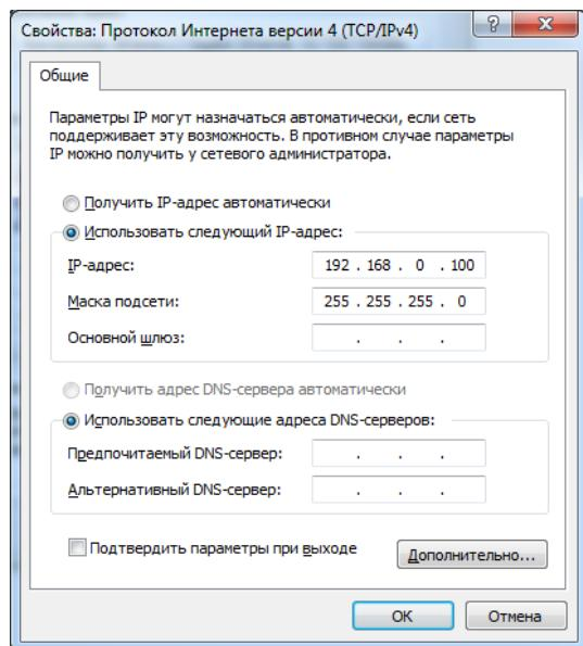
Альтернативный вариант, если компьютер использует статический адрес, добавить ему ещё один, нажав кнопку «Дополнительно» на предыдущем рисунке.
