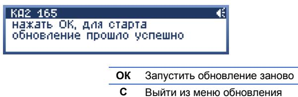
Обновление может продолжаться несколько минут, в зависимости от количества устройств на RS-485 интерфейсе, а также скорости обмена данными.
