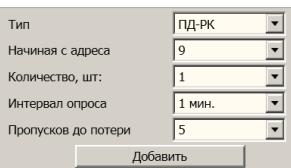
Последние два параметра аналогичны общим настройкам «Период опроса» и «Попыток до потери связи», только относятся к добавляемому устройству. В дальнейшем они могут быть изменены.
