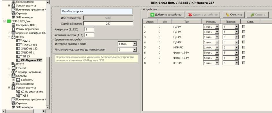
Добавлять, удалять устройства в Конфигураторе можно автономно, без установленной связи с ППК.
