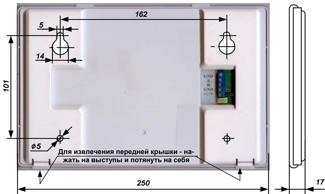
**Рис. 2 Внешний вид, габаритные и присоединительные размеры.**
