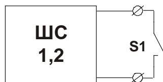
Схема 6 Подключение НР контактов без контроля целостности линии связи.
