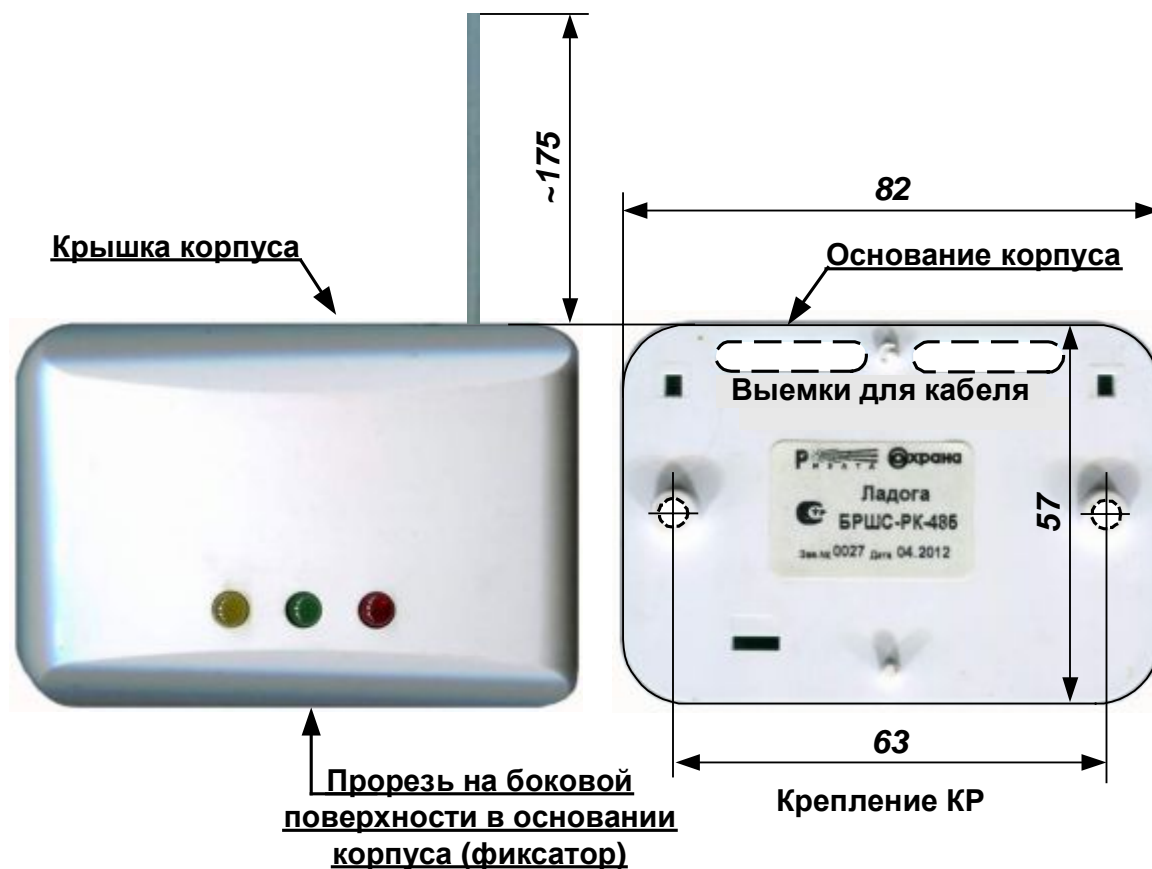
Рис. 3 Габаритные и присоединительные размеры
